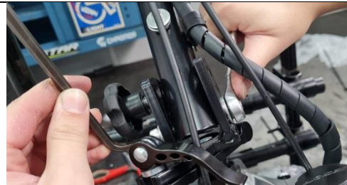
Etapa 11: Afrouxar parafuso da coluna de direção. (Não é necessário remover). Utilizar as chaves Allen 6mm e Combinada 13mm.
