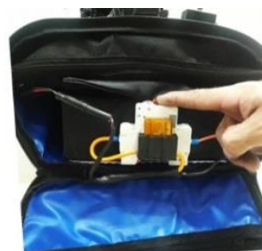
Passo 6 - Ligue a chave disjuntora de segurança.
