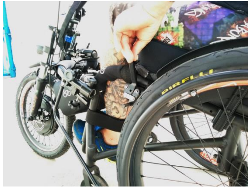
Figura 39 - Destreamento dos freios de estacionamento da cadeira de rodas – * Imagem meramente ilustrativa.
