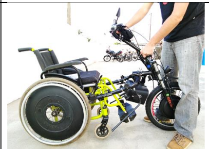
Passo 9: Inserir o manípulo na posição adequada.
