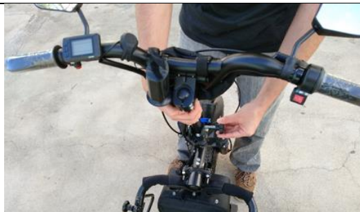
Passo 8: Ajustar a distância do guidão em relação à cadeira. Recomendável: Utilizar inicialmente a 2ª furação da coluna de direção.
