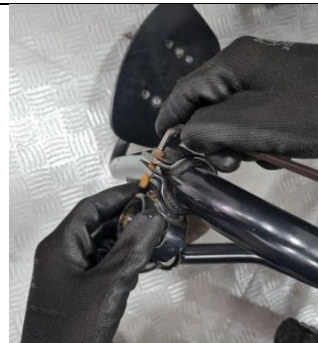
Etapa 2: Remover mancal da cadeira. Utilizar Chave Allen 5mm.
