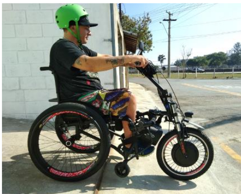
Figura 51 - Descida de calçadas com o KIT LIVRE® (2ª posição) – * Imagem meramente ilustrativa.
