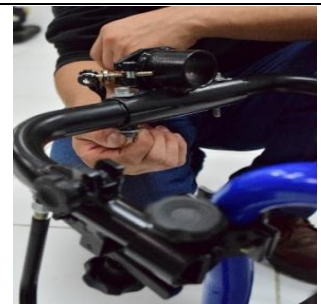
Passo 9: Inserir os parafusos (24,25) sobre o centro do suporte (8). Recomendável: Utilizar inicialmente o segundo conjunto de furação.
