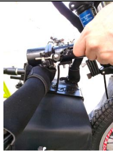
Passo 5: Apertar o parafuso (7) do pino de blocagem (5) no centro do suporte.
