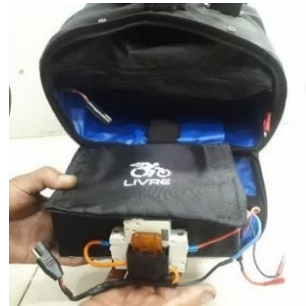
Passo 4 - Retire a bateria da bolsa.
