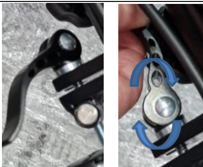
Etapa 20: Levantar e rotacionar a blocagem até remover-la.
