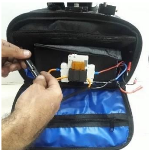
Passo 3 - Desconecte o terminal de conexão da bateria do terminal do controlador.
