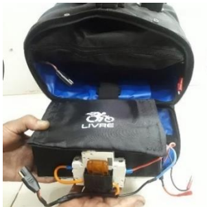
Passo 3 - Insira a bateria na bolsa.
