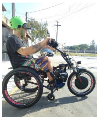
Figura 52 - Descida de calçadas com o KIT LIVRE® (3ª posição) – * Imagem meramente ilustrativa.
