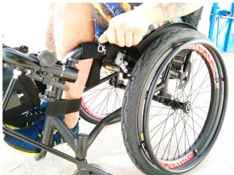
Figura 41 - Travamento dos freios de estacionamento da cadeira de rodas – * Imagem meramente ilustrativa.
