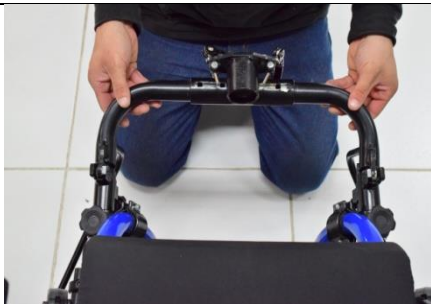
Passo 7: Posicionar o suporte sobre os acoplamentos laterais (17,18).
