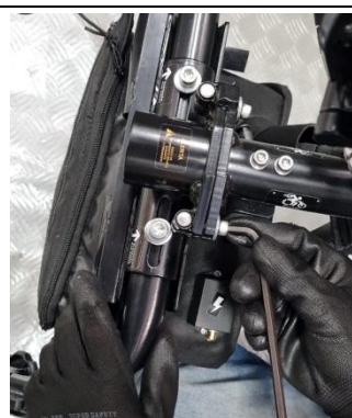
Etapa 4: Destruvar o pino de bloqueio. Utilizar Chave Allen 5mm.
