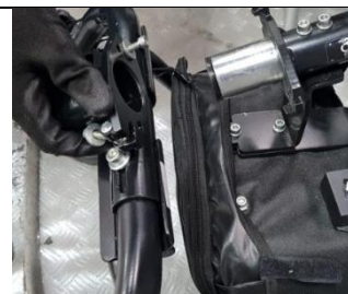
Etapa 6: Remover suporte de acoplamento.
