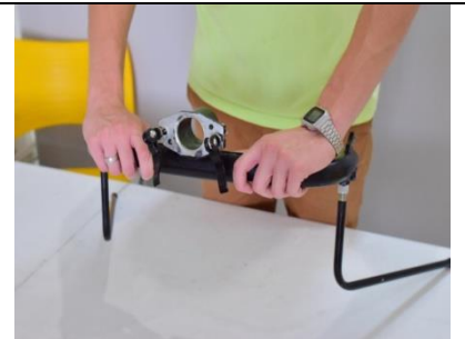
Passo 6: Posicionar o centro do suporte (8) com o acoplamento central para cima.
