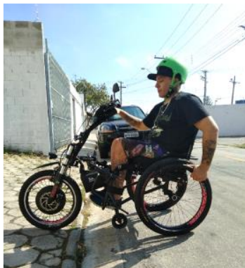
Figura 49 - Subida de calçadas com o KIT LIVRE® com auxílio de propulsão na roda traseira – * Imagem meramente ilustrativa.
