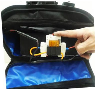
Passo 1 - Desligue a chave disjuntora de segurança.
